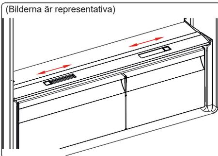
Om grönsakslådan är helt full bör fuktreglaget som finns på framsidan av grönsakslådan öppnas. Detta gör att luften och luftfuktigheten i grönsakslådan kan kontrolleras för att öka livslängden på maten där.
