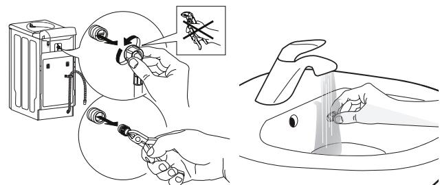
4. Sätt in nätfiltret igen. Anslut inloppsslangen till vattenkranen och tvättmaskinen igen. Använd inte verktyg för att ansluta inloppsslangen. Öppna vattenkranen och kontrollera att alla anslutningar är täta.
