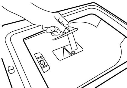
3. Sätt tillbaka behållaren genom att föra in behållarens nedre flikar i de avsedda öppnarna i luckan och trycka behållaren mot luckan tills den sitter på plats.
