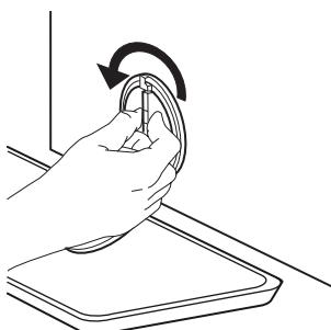
4. Ta bort filtret: Din tvättmaskin är utrustad med flera automatiska säkerhets- och feedbackfunktioner. Ta sedan bort vattenfiltret genom att vrida det utåt i moturs riktning.
