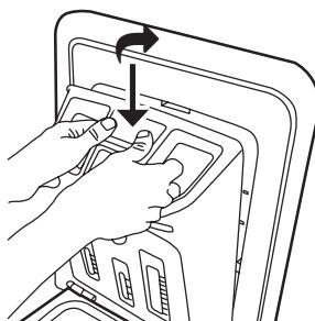
2. Tvätta behållaren under rinnande vatten. Du kan även ta bort sifonpluggen på baksidan av behållaren för rengöring. Sätt tillbaka sifonpluggen i behållaren (om den togs bort)
