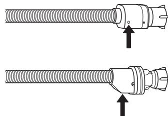
För vattnets stoppslangar: kontrollera det lilla inspekionsfönstret för säkerhetsventilen (se pilen). Om den är röd har vattnets stoppfunktion aktiverats och slangen måste bytas ut mot en ny.
