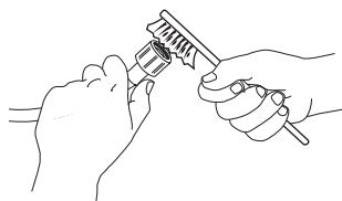
3. Skruva nu loss tilloppsslangen på tvättmaskinen baksida för hand. Ta ut nätfiltret ur ventilen på baksidan av tvättmaskinen med en universaltång och rengör det noga.
