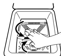
**OBS!** Kontrollera att inget plagg fastnar mellan flänsarna eller mellan flänsarna och trumman. Försäkra dig om att trummans flänsar är ordentligt stängda - beroende på modell:
