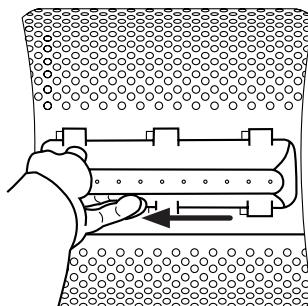
6. Stäng trumflänsarna igen, vrid trumman ett halvt varv och kontrollera bladets placering på alla dess förankringspunkter.
