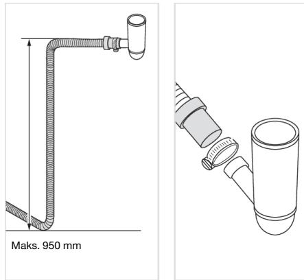
Afløbsslangen kan tillige føres til en tilslutningsstuds ved køkkenvaskens vandlås. Tilslutningsstudsens indvendige diameter skal mindst være 14 mm.
