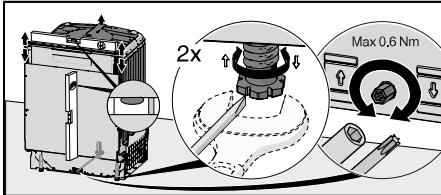
4. Juster de forreste fodder ved at dreje dem med uret for at hæve eller mod uret for at sænke.
