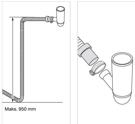
Avløpsslangen kan også føres til en tilkoblingsnippel ved kjøkkenvaskens vannlås. Tilkoblingsnippelens innvendige diameter må være minst 14 mm.
