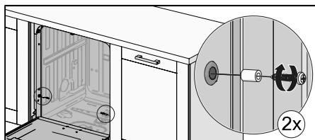
Kontroller, at de forreste fodder hviler på gulvet, når du har skruet maskinen fast.
